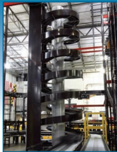
Los Transportadores Verticales en Espiral Ryson requieren un área de planta menor que los transportadores convencionales, son además más rápidos y confiables que cualquier otro ascensor o elevador. Los Espirales Ryson provéen un flujo continuo de producto y requieren un área de planta reducida, mínimo mantenimiento y tienen una vida útil prolongada.
